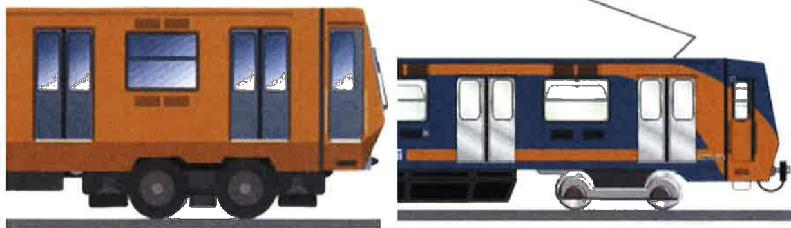
Figura I.2 Laminado con base neumática (lado izquierdo) versus laminado con base de acero (lado derecho)
