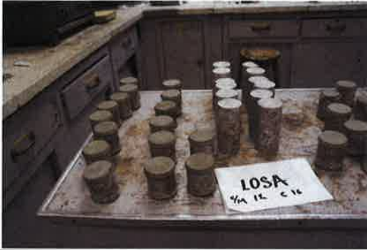
Desembalaje de los núcleos de concreto en el laboratorio de la Gerencia de Estudios de Ingeniería Civil
