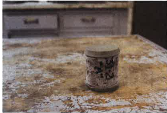
Ejemplo de preparación del núcleo de concreto (después del corte, secado y pulido del núcleo)
